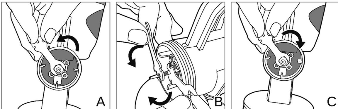
1. 使用內附的一個扳手將噴頭拆下。(圖 A)
